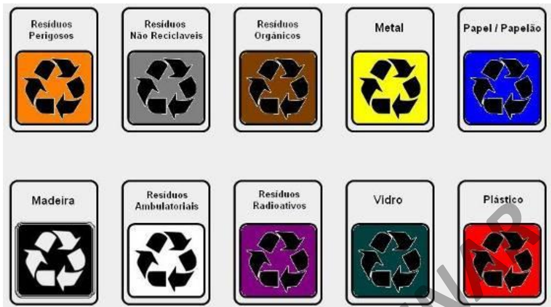
Figura 14 – Códigos de cores para diferentes tipos de resíduos, estabelecido pela Resolução CONAMA nº 275/2001
