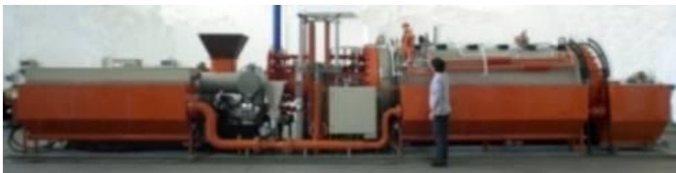
Figura 12 - Reator projetado para a tecnologia Dismo.
